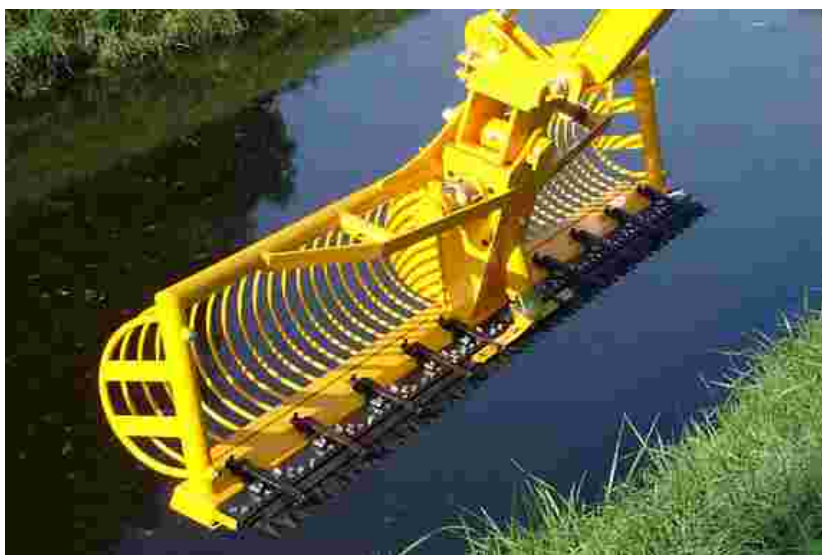
Figura 7.6: benna falciante, montata sul braccio girevole d'un trattore, utilizzata per la manutenzione dei canali.
